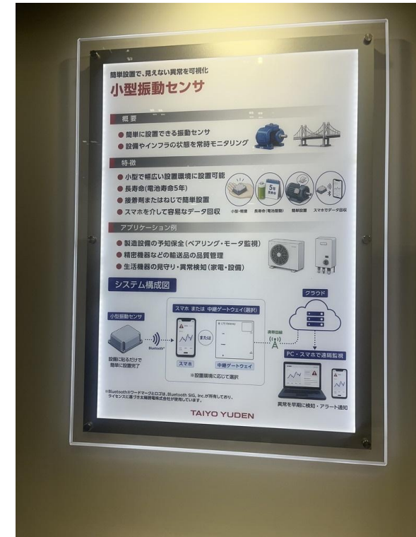
小型振動センサと監視システム
